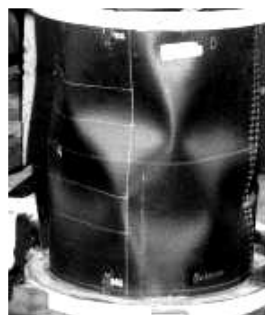
شکل ۵- مود کمانش ایجاد شده در «الف» تحلیل استاتیک غیرخطی، «ب» تحلیل دینامیکی و «ج» نمونه‌ی آزمایشگاهی [۱۷]
