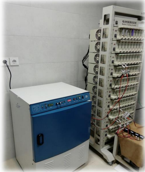
شکل ۱- دستگاه تست باتری BTS3000 ساخت شرکت نیوور به همراه انکوباتور ساخت شرکت پارس‌آزما به‌منظور کنترل دمای محیطی باتری لیتیوم-یونی. (آزمایشگاه باتری پژوهشکده مکانیک)
