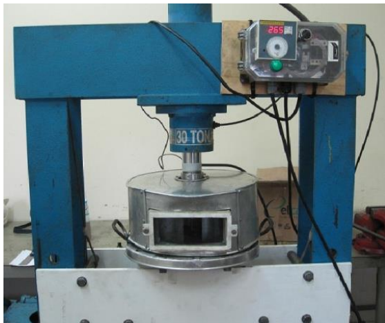
شکل ۲: محفظه ترموستاتیک به همراه دستگاه پرس و سیستم کنترل دما
