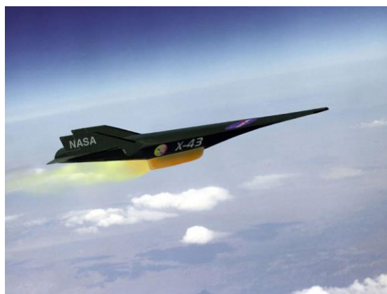
شکل ۱: پرنده ایکس-۴۳ ناسا با موتور اسکرمجت [۵]
