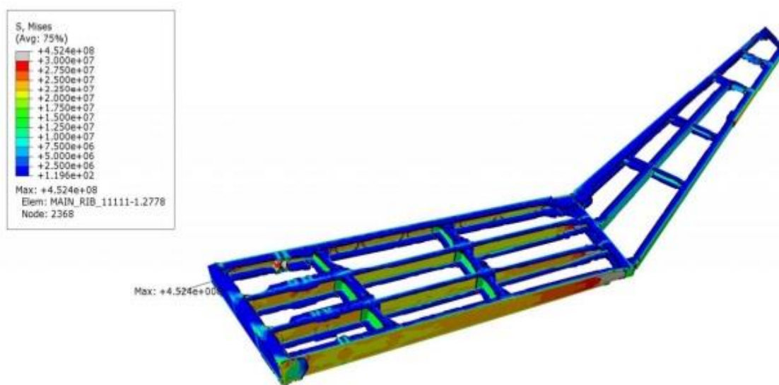
شکل ۱۷: کانتور تنش فون مایز در سازه جعبه گشتاور
