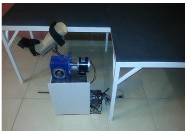
شکل ۷: نمونه اولیه ساخته‌شده از مکانیزم توان‌بخشی پایین‌تنه
