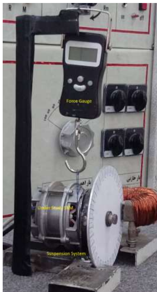
شکل ۵- موتور مورد مطالعه و تجهیزات تست
