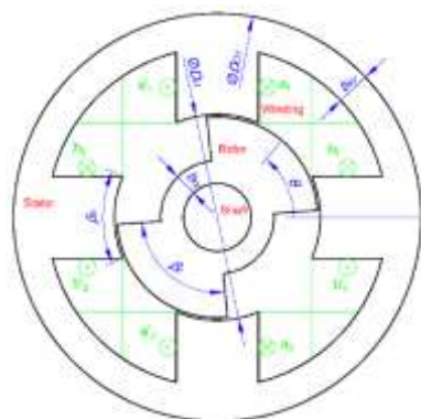
شکل ۱- موتور سوئیچ رلوکتانس مورد مطالعه با روتور معمولی
