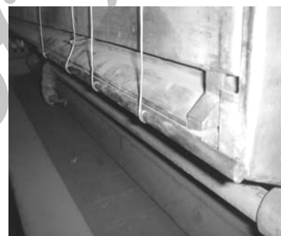
شکل ۲۷- نمای جانبی استوانه‌ها با دو قطر متفاوت، نمای از محل قرارگیری استوانه در لبه زیرین جت و نحوه بستن استوانه به لبه زیرین یکی از جتها
