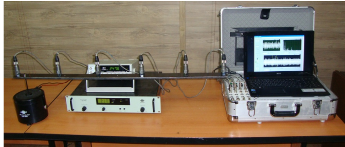
شکل ۴- تصویر آزمون آزمایشگاهی تیر فولادی
