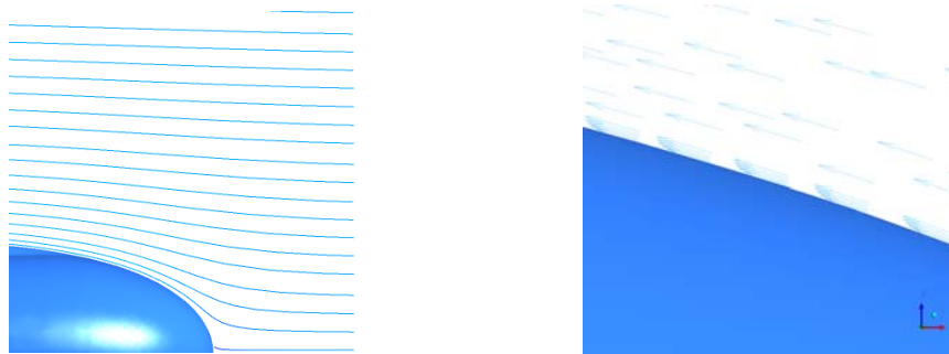
شکل ۷- بردارهای سرعت و خطوط جریان حول شناور بر روی مقطع دوبعدی گذرنده از دامنه محاسباتی
