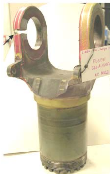
شکل ۱۸- نمونه تجربی اسپیندل پس از شکست [۲۸]
