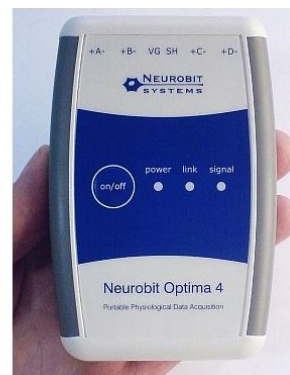
تصویر ۶- راست: ابزار ثبت فعالیت الکتریکی پوست، ضربان قلب و تنفس (شرکت Neurobit)، چپ: هدست ثبت فعالیت مغز (شرکت NeuroSky).
