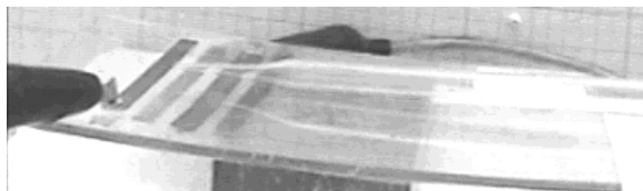
شکل ۳-الف) قطعه محرک پلاسمای دی‌الکتریک؛ نمای طرح از جهت باد الکتریکی القایی، (ب) تصویر از پلاسمای تولید شده توسط DBD روی یک ورقه پلی‌کربنات
