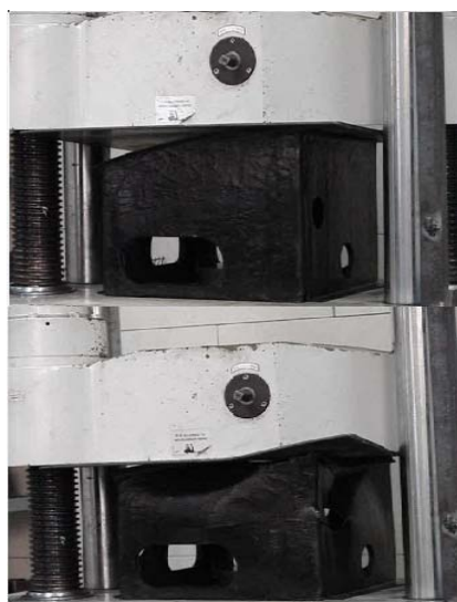
شکل ۱۳- شکل آزمایش شبه استاتیکی
