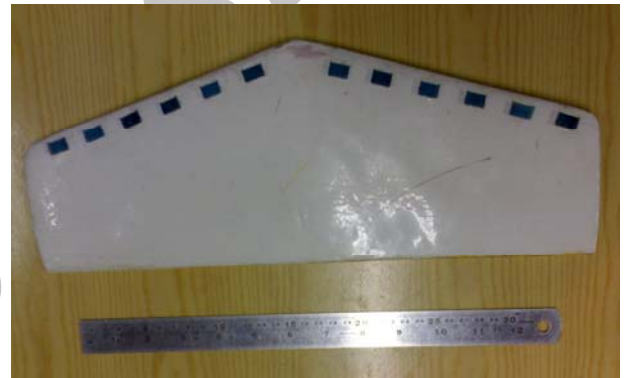
شکل ۴- نمائی از مدل آزمایشگاهی با تولید کننده گردابه با زاویه سمتی صفر درجه
