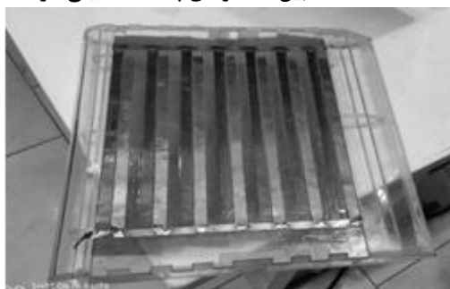
ب) فاصله بین عملگرهای پلاسما ۱۰ میلی متر
