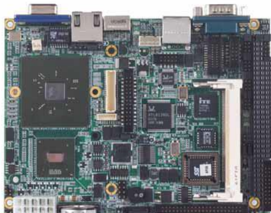
شکل ۳- پردازنده هدف SBC84710 مورد استفاده در تست پردازنده در حلقه در محیط xPC-Target نرم افزار متلب
