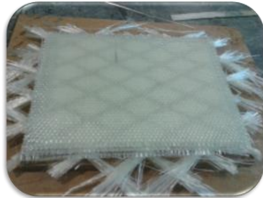
شکل ۴- اتصال پارچه آغشته به رزین رویه بالایی بر روی هسته (در حالت ژله‌ای)
