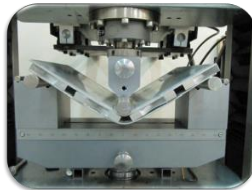
شکل ۲۰ - واماندگی نمونه شماره ۴ در لحظه پایان تست
