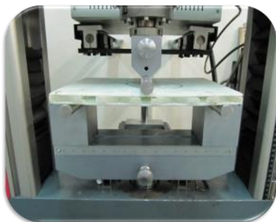
شکل ۱۱- قرار گیری نمونه اول بر روی تکیه‌گاه‌های خمش سه نقطه‌ای و بارگذاری در مرکز نمونه
