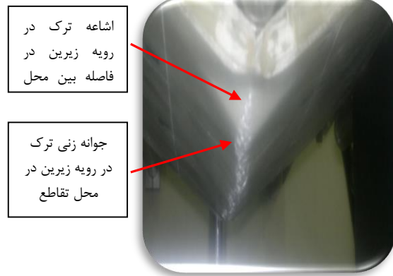
شکل ۱۶- جوانه زنی و اشاعه ترک در رویه زیرین نمونه شماره ۲
