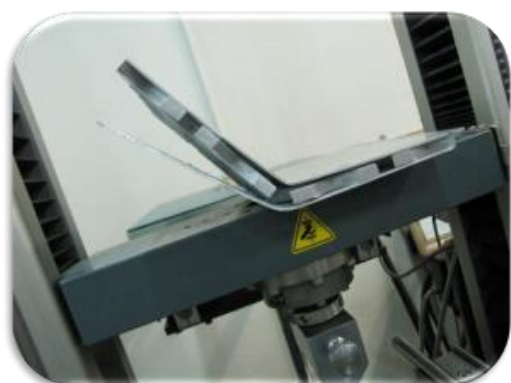
شکل ۲۲ - جدایش هسته از رویه‌ها پس از باربرداری (پایان تست نمونه شماره ۴)
