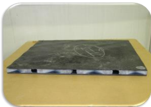
شکل ۸- نمونه شماره ۳ با رویه‌های الیاف کربن (پس از برش زوائد اضافی)
