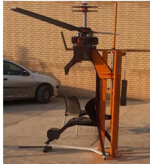
شکل ۲۵- سامانه تست ارتعاشات و برآ، با یک مجموعه پره
