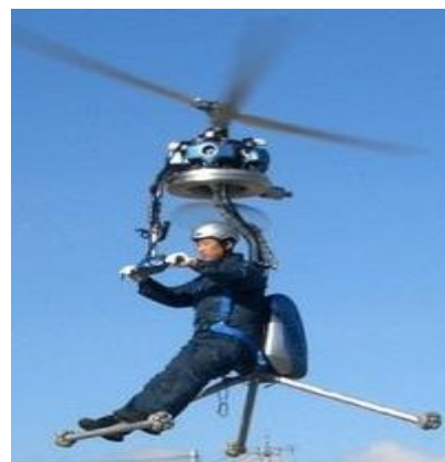
شکل ۴ - تصویر بالگرد تک سرنشین با موتورهای سوختی [۱۱]
