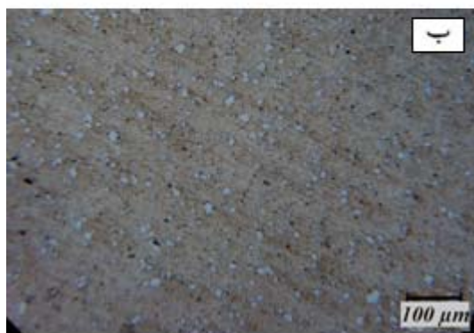
شکل (۸): تصویر میکروسکوپ نوری، (الف): کامپوزیت \text{Al/5 vol.\%Ni}_3\text{Al} و (ب): کامپوزیت \text{Al/5 vol.\%(Ni}_3\text{Al+Al}_2\text{O}_3) تفجوشی شده در دمای 620^\circ\text{C} .
