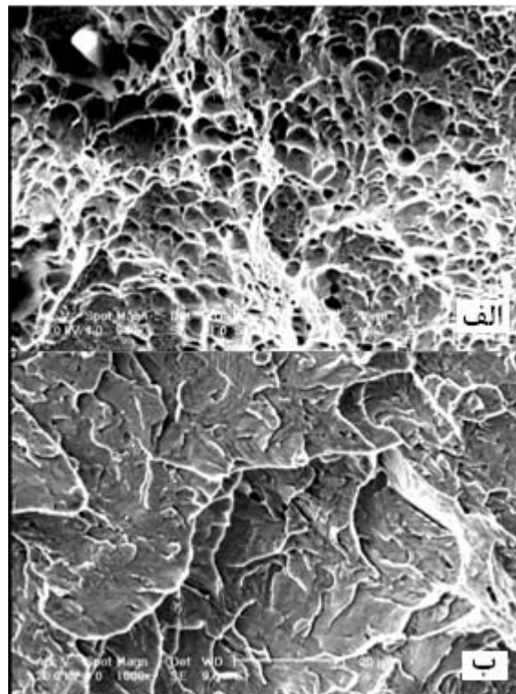
شکل (۱۱): سطح شکست در مود فصل مشترکی، الف) منطقه شکست نرم با مشخصه دیپلی و ب) منطقه شکست ترد با مشخصه کلیواژی در لبه دکمه جوش.
