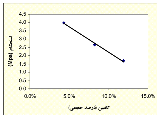
شکل (۱۱): اثر میزان کافتین بر استحکام چسبندگی فصل مشترک.
