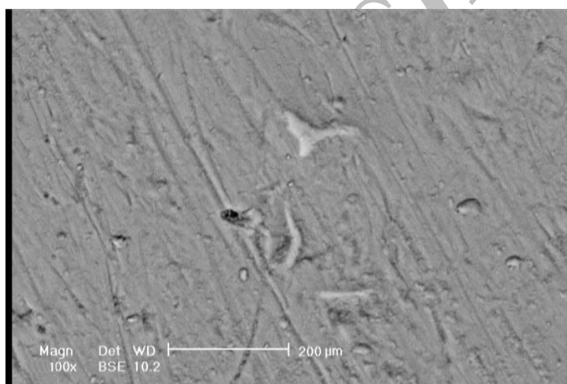
شکل (۴): تصویر میکروسکوپ الکترونی روبشی از سطح سایش نمونه با پوشش کامپوزیتی.
