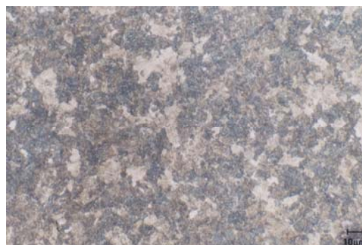
شکل (۳): ریز ساختار حاصله از نمونه ای که عملیات حرارتی اشاره شده در شکل ۳ بر روی آنها انجام گرفته است.
