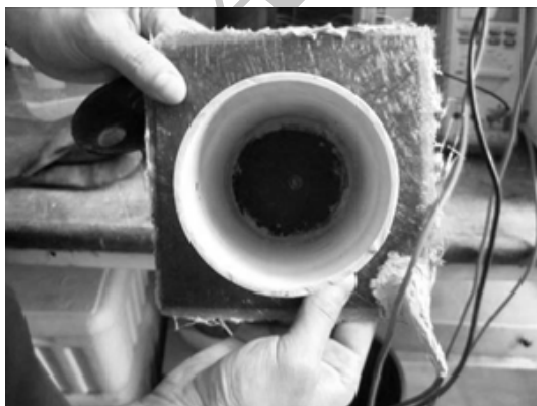
شکل (۴): نحوه آماده‌سازی نمونه و سلول الکتروشیمیایی برای آزمایش جدایش کاتدی
