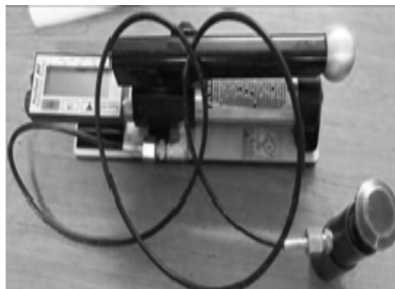
شکل (۲): آزمایش گر میزان چسبندگی نوع V که به طور خودکار تراز می‌شود.
