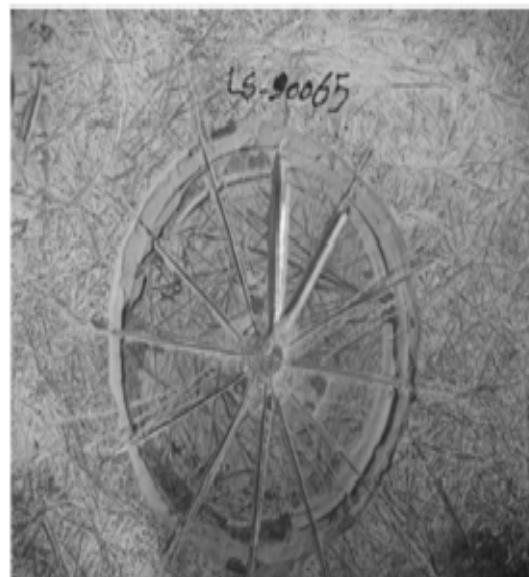
شکل (۶): چگونگی ایجاد برش‌های شعاعی بر روی نمونه پس از انجام آزمایش جدایش کاتدی
