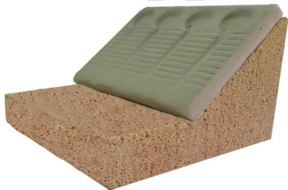
شکل (۱): شماتیکی از قرار گرفتن ویسکومتر شیاری بر روی سطح شیبدار با زاویه شیب ۴۵ درجه.
