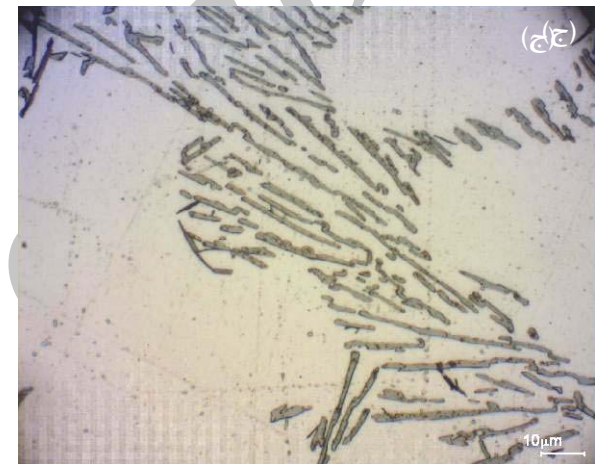
شکل (۵): تصویر میکروسکوپ نوری از ریزساختار: (الف) آلیاژ ریختگی آلتراسونیک شده، (ب) نمونه آلتراسونیک شده ساخته شده به روش افزودن نانوذرات به مذاب آلیاژ، (ج) فاز یوتکتیک در آلیاژ ریختگی و (د) فاز یوتکتیک در نمونه آلتراسونیک شده تهیه شده به روش افزودن نانوذرات به مذاب آلیاژ.
