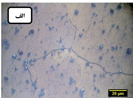
شکل (۶): ریزساختار متالوگرافی نمونه ۰/۴ درصد تیتانیوم بعد از عملیات حرارتی: الف) ۲۰۰X و ب) ۱۰۰۰X.
