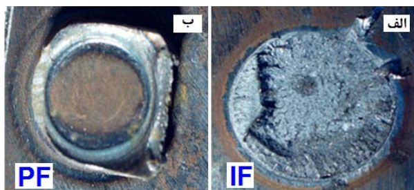
شکل (۷): (الف) سطح شکست در مود فصل مشترکی، (ب) نمونه شکسته شده در مود محیطی
