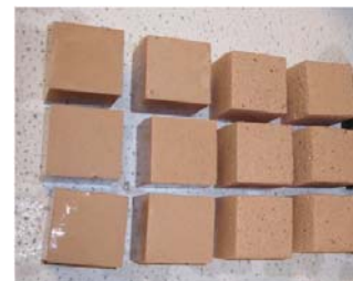
شکل (۳): نمونه ژئوپلیمری پس از خروج قالب
