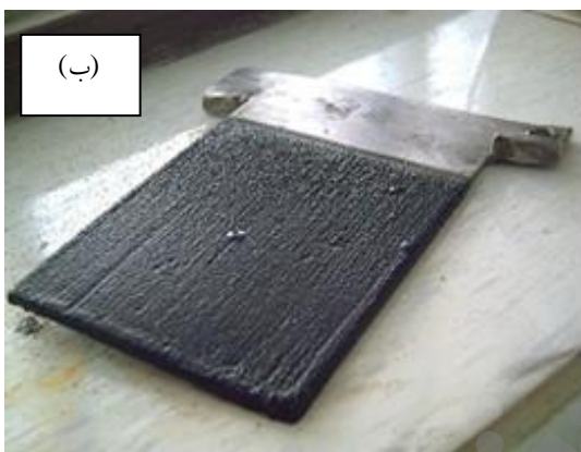
شکل (۲): (الف): رسوب تولید شده در pH ۳، (ب): رسوب تولید شده در
