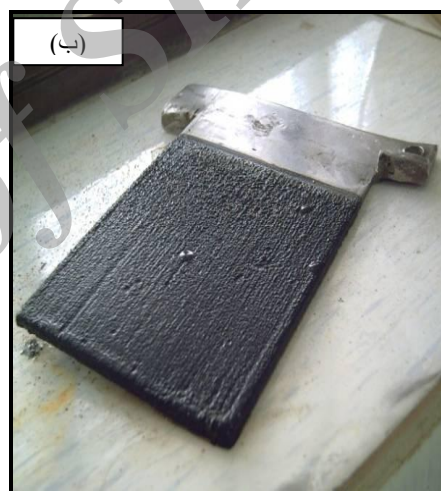
شکل (۶): تاثیر دما بر روی شکل ظاهری رسوب آهن بر سطح کاتد (الف): دمای 25^{\circ}\text{C} و (ب): دمای 60^{\circ}\text{C}
