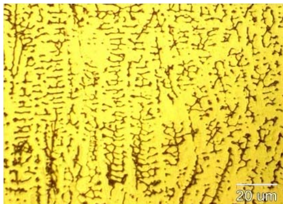
شکل (۶): ریزساختار میکروسکوپ نوری فلز جوش ۳۰۹LMo
