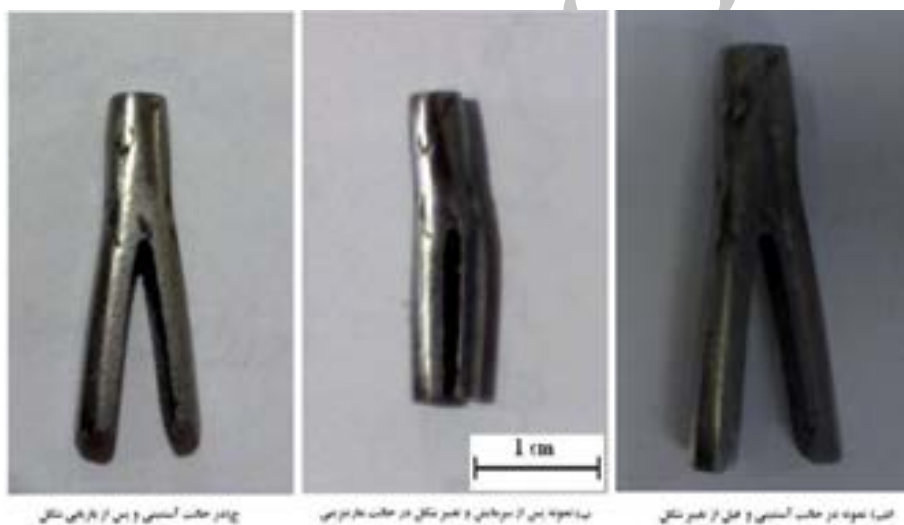
شکل (۱۲): ایمپلنت دندان ساخته شده در حالت های مختلف بروز رفتار حافظه داری.
