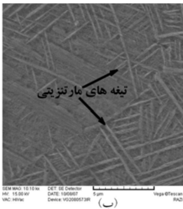
شکل ۹: تصویر میکروسکوپ الکترونی از نمونه پس از عملیات پیرسازی: (الف): زمینه مارتنزیتی و فاز های رسوب کرده در مرز دانه ها، (ب): تیغه های مارتنزیتی در بزرگنمایی بالاتر
