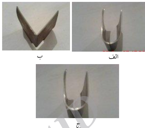
شکل (۵): تصویر سطح خمش جوش نمونه‌های: (الف): A (100% Ar)، (ب): D (85% Ar+15% CO 2 ) و (ج): I (50% Ar+50% CO 2 )
