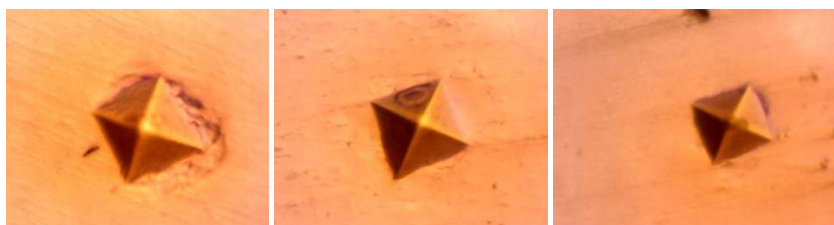
شکل (۱۲): نمودار سختی نمونه های حاصل از فرایند FWS در فولاد X65 به همراه تصویر اثر فرورونده الماسی
