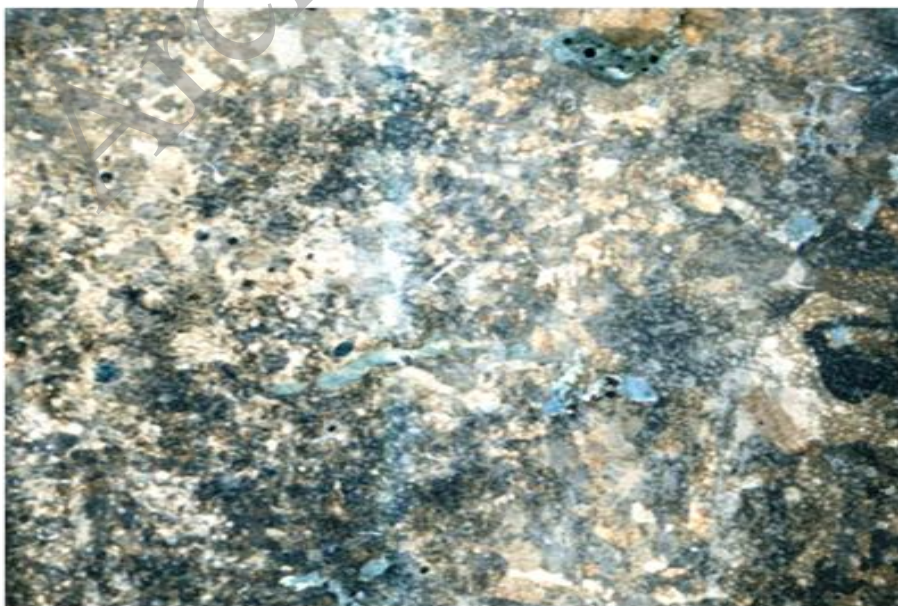
شکل (۱۵): ماکروساختار نمونه‌ی شمش آلیاژ ذوب مجدد شده در VAR
