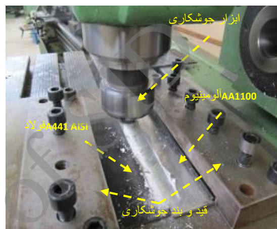
شکل (۲): نحوه ی قرارگیری ورق ها در قید و بند جوشکاری
