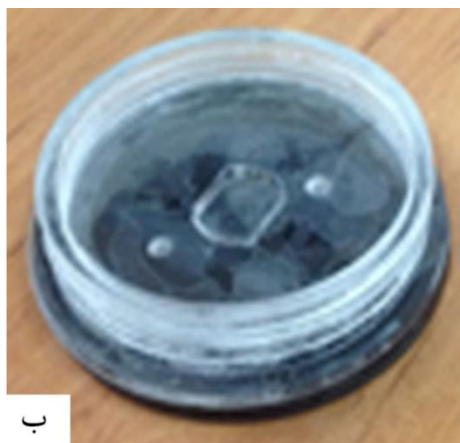
شکل (۱): (الف): نحوه حرکت پین روی دیسک، و (ب): نگهدارنده مورد استفاده برای آزمایش های محیط تر
