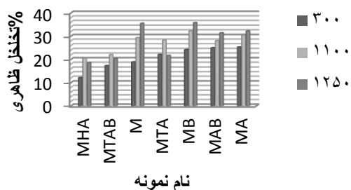
شکل (۲): نتایج تخلخل ترکیبات پایه ضایعات فرآورده‌های منیزیایی
