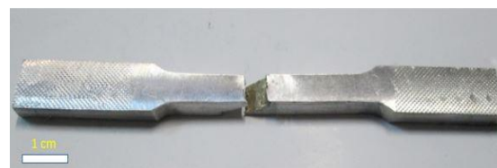
شکل (۱۲): نمونه آزمون کشش شکسته شده از ناحیه اغتشاشی
