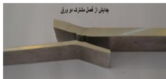
شکل (۹): محل شکست نمونه جوشکاری شده با طول نقص پیوند تماسی زیاد
