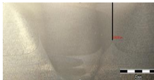
شکل (۴): درشت ساختار نمونه جوشکاری شده با پین مخروطی ناقص پله دار در حرارت ورودی بالا
