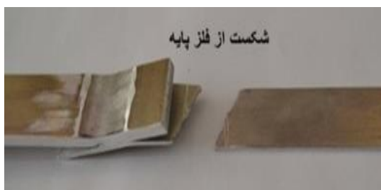
شکل (۱۰): محل شکست نمونه جوشکاری شده با ارتفاع هوک بهینه و طول نقص پیوند تماسی مناسب
