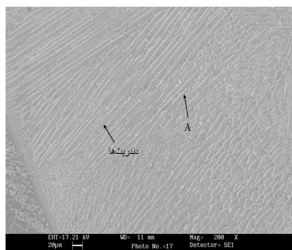
شکل (۷): تصویر میکروسکوپ الکترونی ساختار منطقه جوش فلز پرکننده
