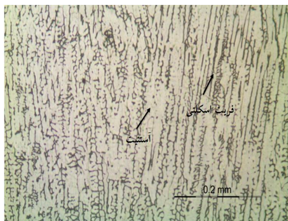
شکل (۳): تصویر میکروسکوپ نوری، ریز ساختار فلز جوش 309L
