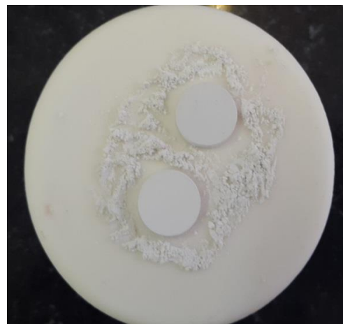
شکل (۱): تصویر قرص‌های پرس شده با قطر ۱۱ mm و ضخامت ۱/۵ mm در بستری از نانوپودرهای تنگستات روی
