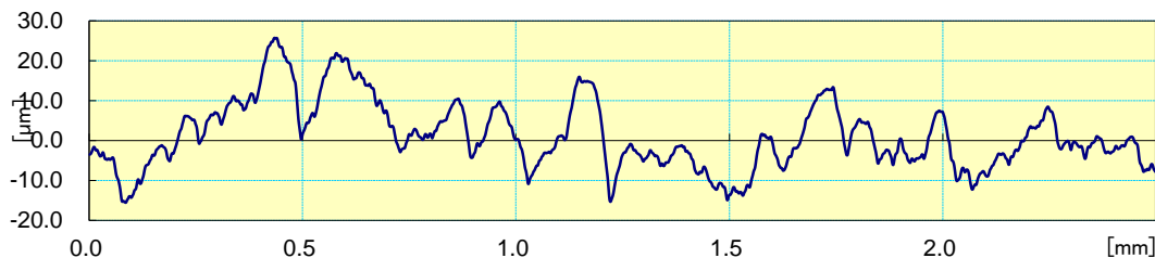
شکل (۶): میکروگراف زبری پوشش
