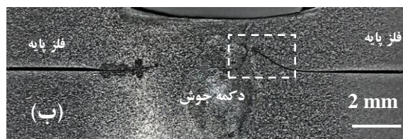
شکل (۶): مقاطع عرضی اتصالات لبه روی هم به دست آمده در زوایای متفاوت سطح شانه: (الف): ۵ درجه و (ب): ۱۰ درجه
