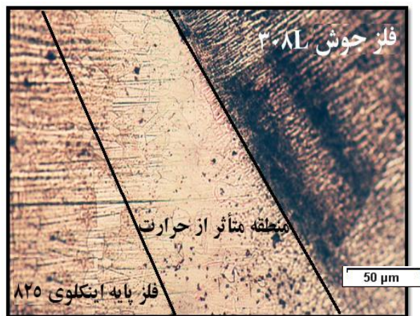
شکل (۷): تصویر متالوگرافی منطقه متأثر از حرارت مربوط به اینکلوی ۸۲۵ با فلز پر کننده ۳۰۸L
