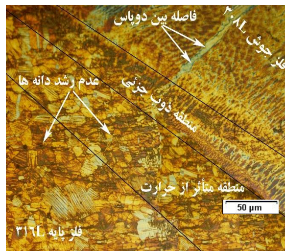
شکل (۸): تصویر متالوگرافی منطقه متأثر از حرارت فولاد زنگ نزن آستنیتی L ۳۱۶ با فلز جوش ۳۰۸L
