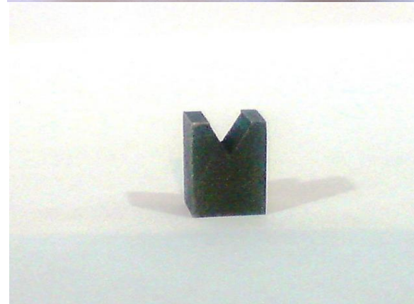
شکل (۱): نمونه سوپرآلیاژ پایه کبالت FSX-414 با شیار های U و V شکل ایجاد شده بر روی سطح آنها
