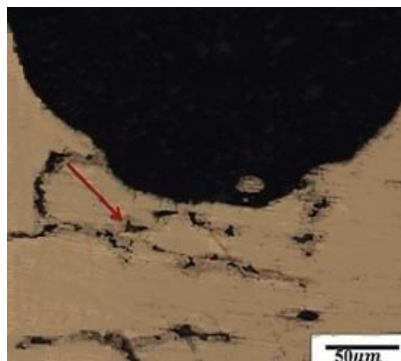
شکل (۸): ریزساختار اتصال (TLP) آلیاژ FSX-414 با شیار V شکل با پودر MBF-100 ساخته شده در دمای ۱۱۷۵ °C به مدت ۳۰ دقیقه
