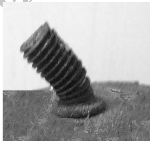
شکل (۱): آزمون خمش برای تایید اولیه کیفیت اتصال
