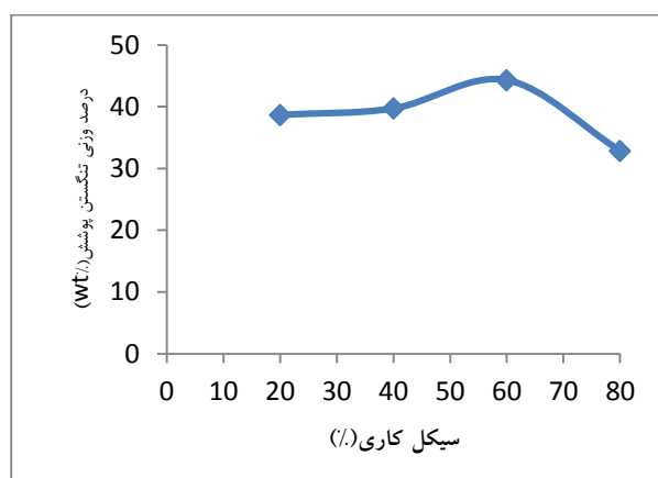
شکل (۶): نتایج آنالیز عنصری پوشش بدست آمده بر حسب سیکل کاری
