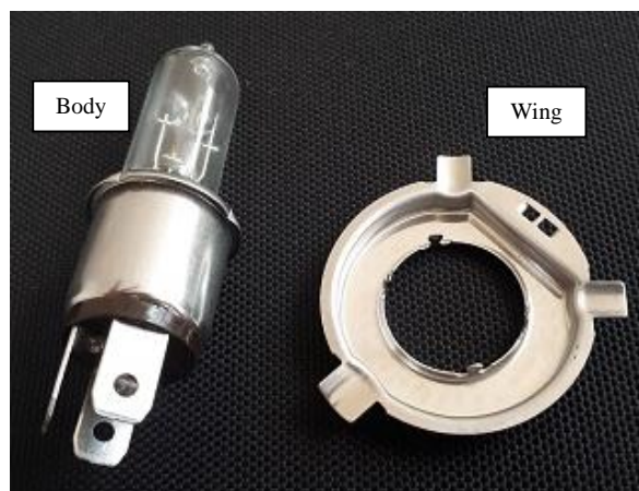
شکل (۲): لامپ هالوژن H4 قبل از جوشکاری وینگ به بدنه
